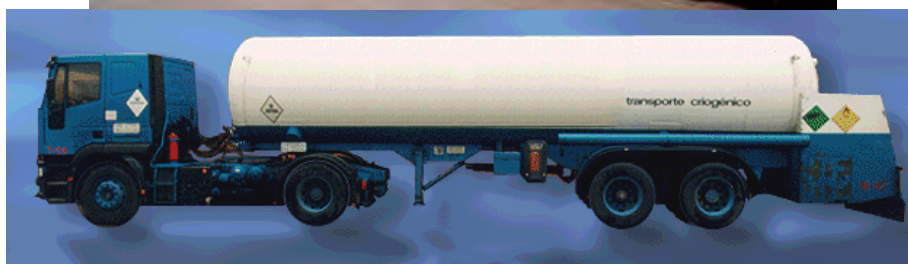
Camions cisterna amb transport de gas líquat: per pressió i per temperatura. Font: Guia planificació municipal Transcat (DGPC).
