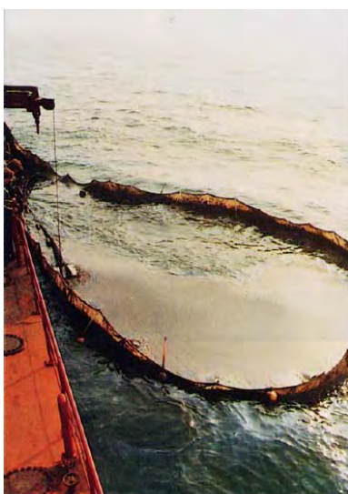
Exemples de recursos: barreres (esquerra), skimmers a bord d'un vaixell anticontaminació (a dalt) i vaixell neteja (a sota). Font: International Maritime Organization (IMO).
