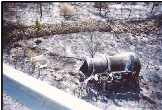
Detall de dos fragments d'una cisterna de propà que va patir una BLEVE a Tivissa l'any 2002. El primer va originar un incendi forestal i el segon va caure damunt d'un habitatge a uns 100 m de l'accident.
