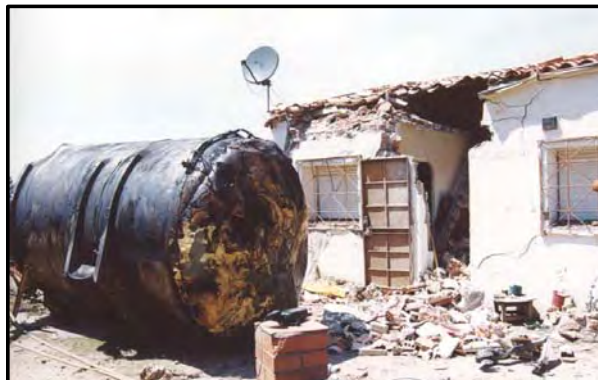
Detall de dos fragments d'una cisterna de propà que va patir una BLEVE a Tivissa l'any 2002. El primer va originar un incendi forestal i el segon va caure damunt d'un habitatge a uns 100 m de l'accident.
